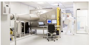
▲ EN 1822-Prüfeinrichtungen sind unerlässlich, um die Qualität und Leistung von HEPA-Filtern zu gewährleisten.
