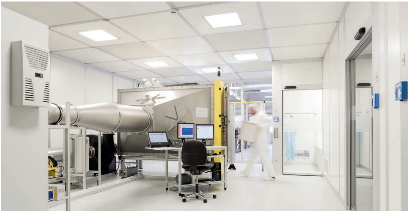
Gesamte Scantest-Anlage im werkseigenen Reinraum
