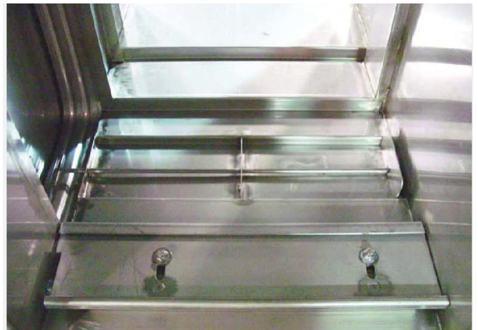
Vue en aval du mécanisme du plateau de verrouillage
