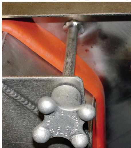
Gros plan du loquet de la porte et du mécanisme de verrouillage du joint d'étanchéité
